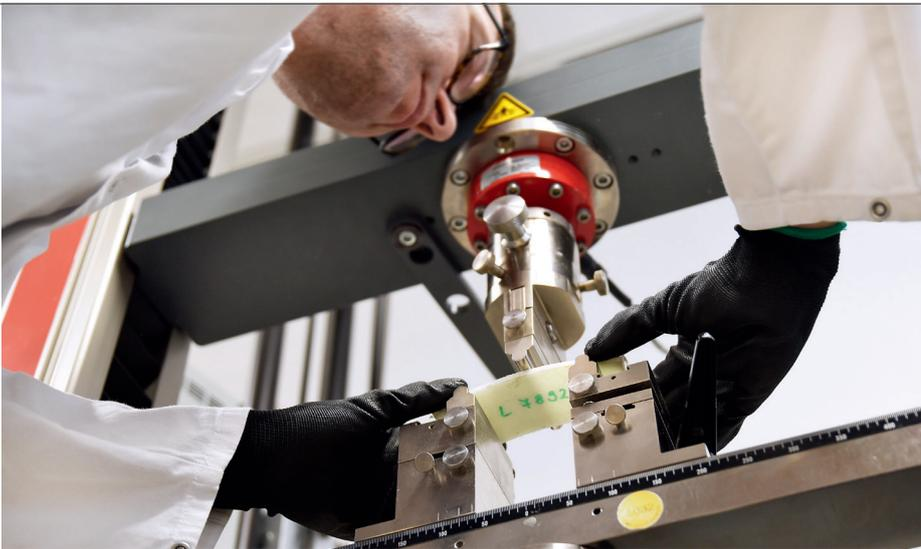
Drei-Punkt-Biegeversuch: mechanische Prüfung von E-Modul und Biegefestigkeit
