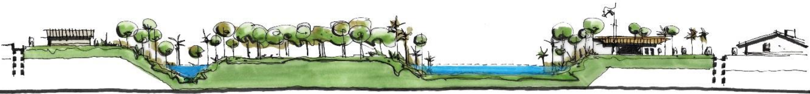
CORTE ESQUEMÁTICO | BACIA DE RETENÇÃO. CHEIA
