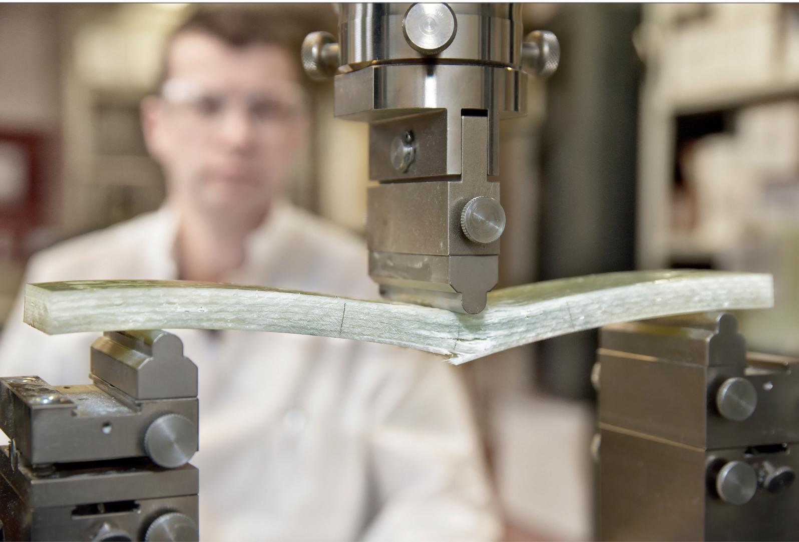
Unter Druck: Der IKT-Prüfer ermittelt die Biegespannung beim Bruch der Linerprobe.
