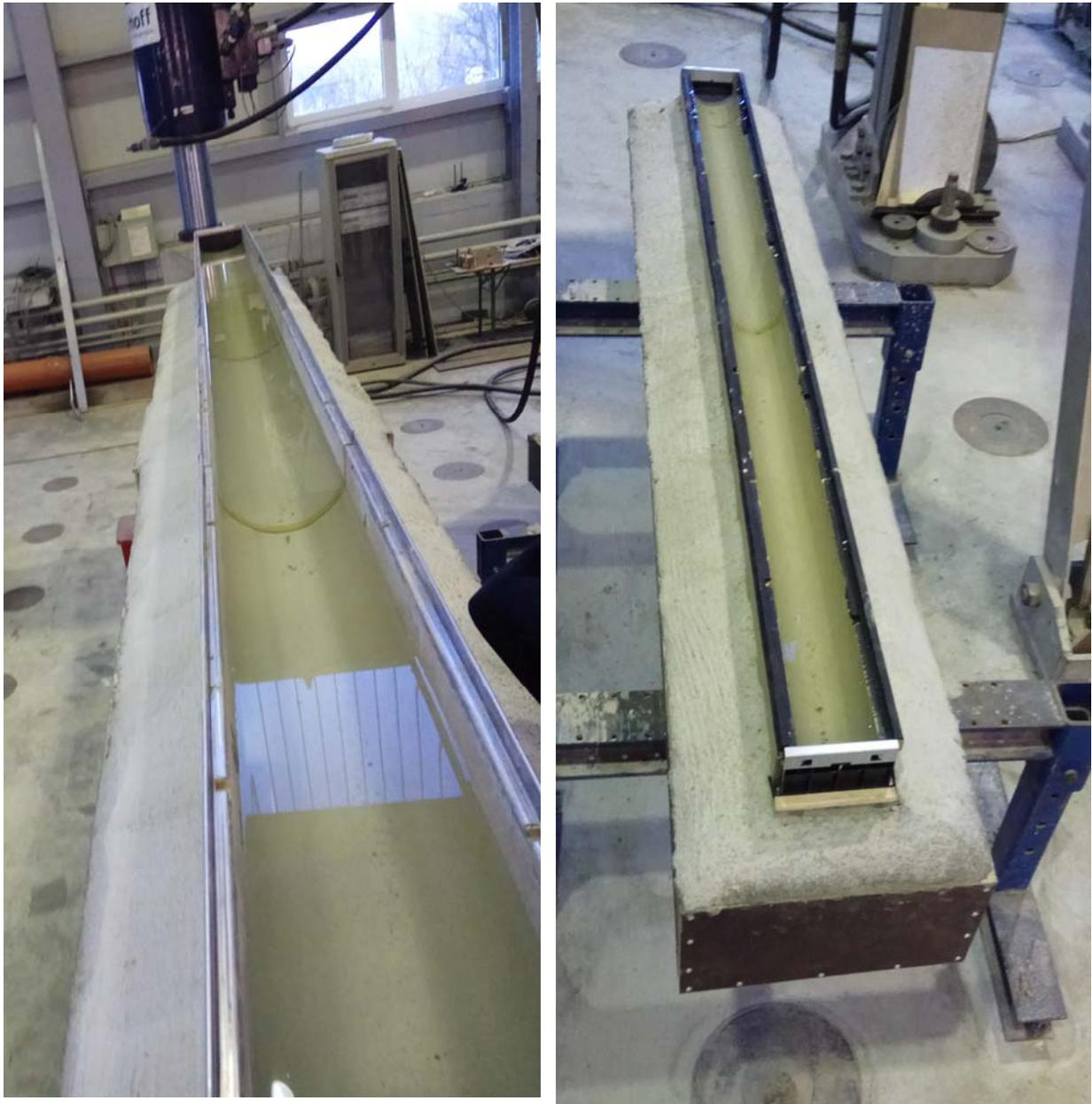
*Abbildung 5: Eingebaute Rinne, NW200 (4m) (links) und NW100 (2m) rechts im Betonbett vor der zyklischen Belastung*
