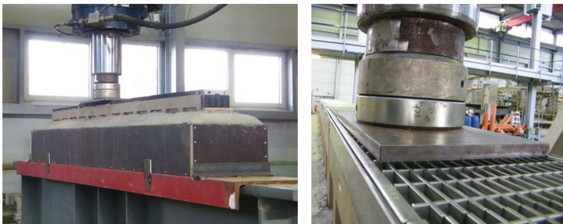
Abbildung 3: Prüfaufbauten für die zyklische Belastung. Links: Prüfaufbau NW100 mit Gusseisenzarge. Rechts: Prüfaufbau NW200 mit Edelstahlzarge.
