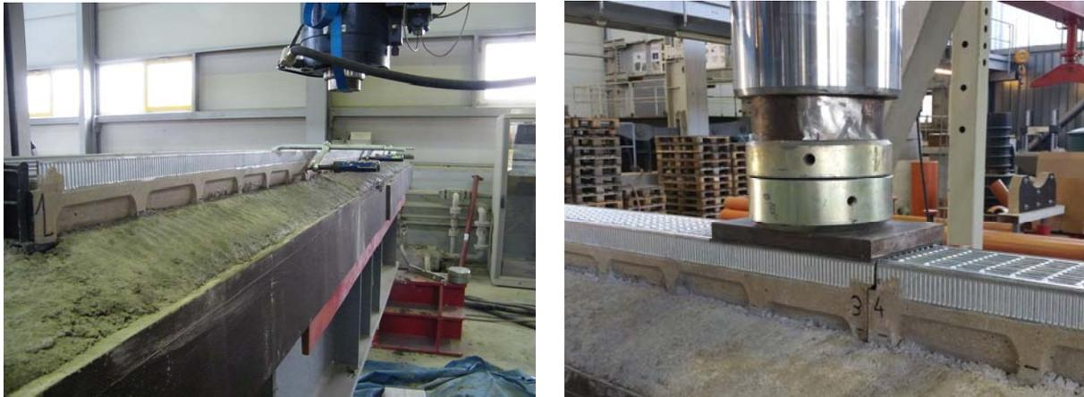
Abbildung 4: Eingebaute Rinne (4m) im Betonbett vor der zyklischen Belastung (links) und Lasteinleitung im Detail (rechts)
