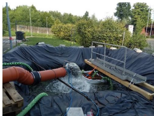
a) Ablauf-Rohrleitung aus dem Drosselbauwerk b) Gedükterter Auslauf ins Tosbecken
