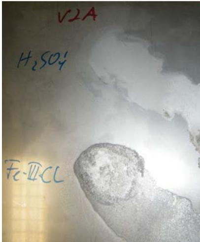
**Bild 10** Mit Eisen(III)-Chlorid- ( $\text{FeCl}_3$ -) Lösung und Schwefelsäure ( $\text{H}_2\text{SO}_4$ ) beaufschlagte Oberflächen einer Vergleichsplatte aus V2A-Stahl (Stahlsorte 1.4301 entsprechend dem verwendeten Stahl aller Drosselorgane im Test): Visuell erkennbare Veränderung an der Oberfläche im Vergleich zu nicht-beaufschlagten Bereichen
