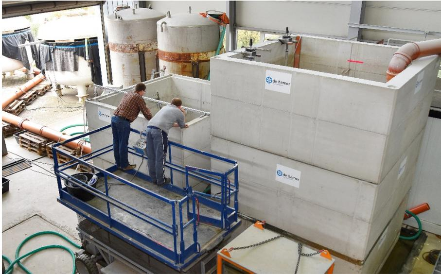
**Bild 3** Versuchsanlage mit Regenbecken, Drosselbauwerk und Vorlagebehältern
